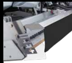
ICEplus Flexi Systém postřiku vodou + Elektricky ovládaná utěrka
